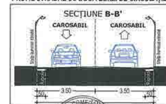
PROFIL STRADAL CU DOUĂ BENZI DE CIRCULAȚIE
